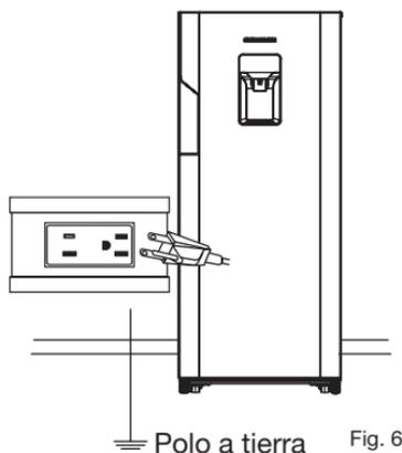
Nota: la conexión de polo a tierra nunca se debe hacer a elementos no adecuados, como líneas telefónicas o tuberías de gas.
