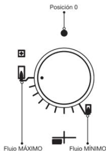
Una vez esté encendido el quemador, suelte la perilla, para Las referencias Cristal 6797 Gamma 6040/41, mantenga oprimido mínimo 5 segundos.
