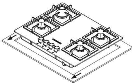
3. Coloque la cinta espumosa en el contorno del vidrio (ver pag.16), luego ubique la cocina en el ruteo garantizando que quede recargada hacia el borde de los controles (frente de la cocina), por la parte inferior verifique que la cocina descanse sobre los bordes metalicos de la misma (NO debe quedar apoyada en el cristal), por ultimo asegúrela con las bridas de fijación.
