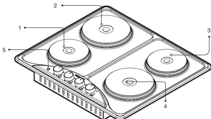
1. Resistencia termoprotégida 6"-1500W 2. Resistencia termoprotégida 8"-2000W 3. Resistencia termoprotégida 6"-1500W 4. Resistencia termoprotégida 8"-2000W 5. Piloto indicador de funcionamiento.
