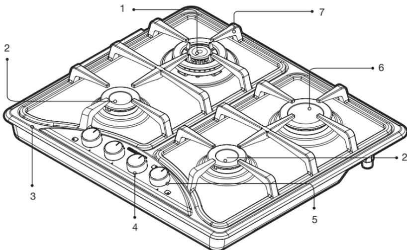
1. Quemador Triple Corona 2. Quemadores Semi-Rápidos 3. Cubierta en acero inoxidable 4. Perillas de agarre ergonómico 5. Encendido electrónico incorporado en cada perilla, solo basta oprimir y girar para obtener llama 6. Quemador rápido 7. Parrillas en fundición.
