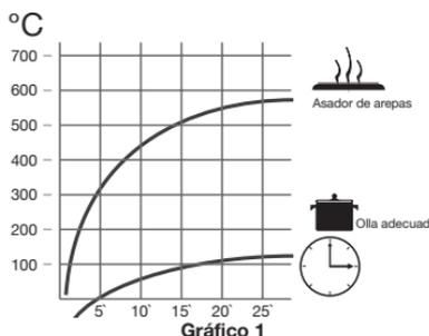
El grafico 1 hace referencia a las temperaturas generadas en el mismo rango de tiempo, aquí se compara la variación de temperatura usando un recipiente adecuado y un asador de arepas que es típico uso inadecuado.
