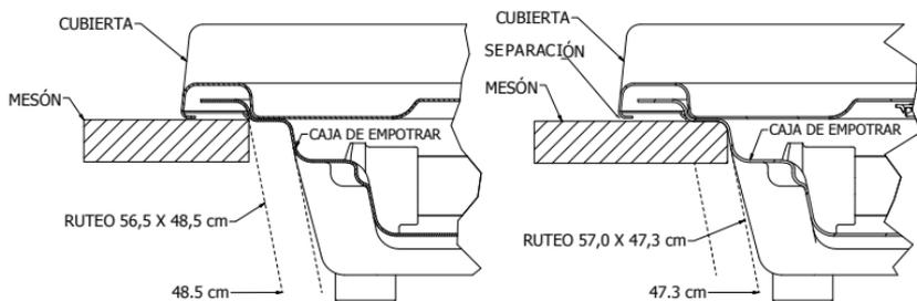
\* La separación máxima permitida es de 3mm entre la base de la cubierta y la superficie del mesón, utilice silicona al contorno para evitar filtraciones.
